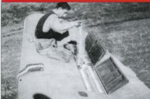
■ Zbrojíř ukládá nábojové pásy do zásobníků pro kulomety ráže 12,7 mm.
